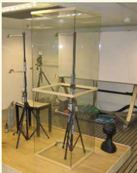
-Figuur 1- Het vitrine-prototype op de testvloer in de klimaatkamer (afbeelding links). Zichtbaar zijn de op de vloer geplaatste statieven met sensoren en diverse dummyobjecten. De afbeelding rechts toont een infraroodopname van de proefvloer met ingeschakelde vloerverwarming.
