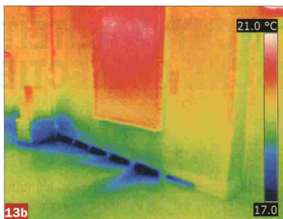
Thermografische opname van een groot schilderij opgehangen boven een luchtinblaasopening
