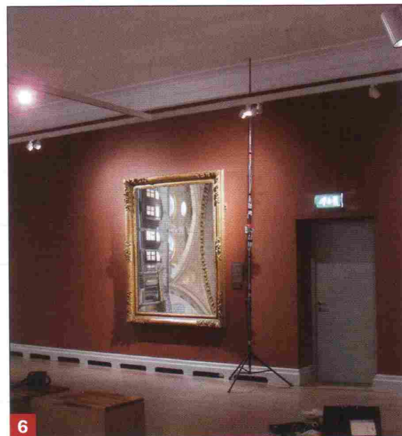
6 Opstelling voor het meten van de temperatuurstratificatie op ruimteniveau
