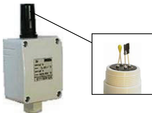
Figuur 17 Een gecombineerde T/RV-sensor. Onder de afschroefbare kap bevinden zich een thermistor en een capacitieve opnemer.
