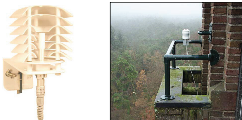
Figuur 21 Het meten van de buitencondities geschiedt met behulp van een gecombineerde T/RV-sensor die is ondergebracht in een speciale afdekkap.
